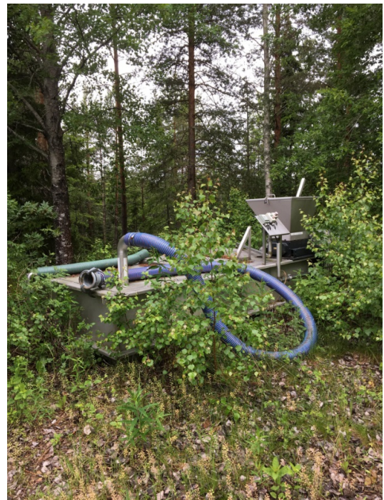
Figur 7: Mottagningsdel med tippficka och kvarn för matavfall.
